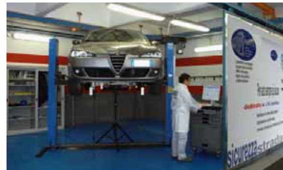
Tra i 'fiori all'occhiello' di Alma 2000 figura il laboratorio di metrologia per la misurazione delle scocche, unico in Italia
